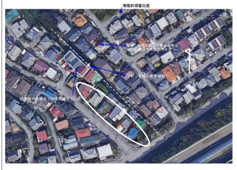
切盛り境に段差・クラックが連続的に発生している。里道より西側は、急崖部を造成した宅地。
