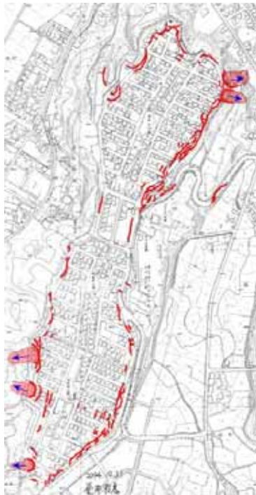
図1 高町団地の亀裂分布図 (釜井原図) 団地の外周に被害が集中している。
