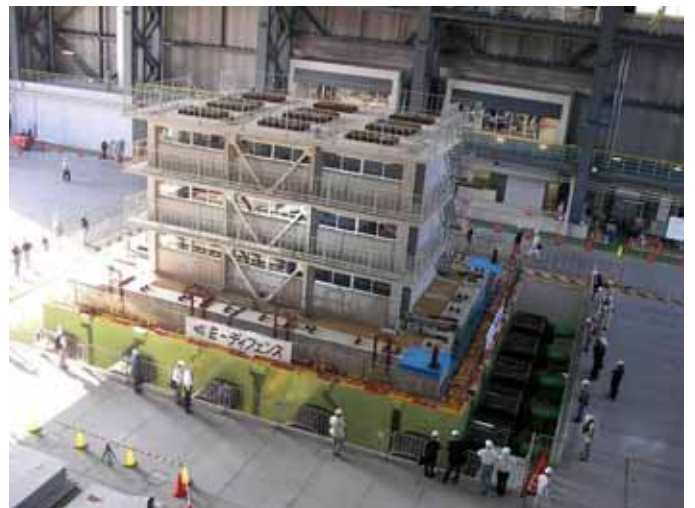
（今回10月の実験状況(建物基礎は直接基礎とし、砂質土の上に建築されている) この後、さらに基礎を振動台に剛結して実験が行われる予定
