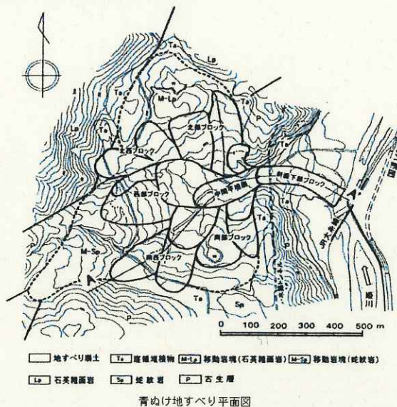
図 5.2.12 青ぬけ山地すべり (新潟県) のボトルネック構造
