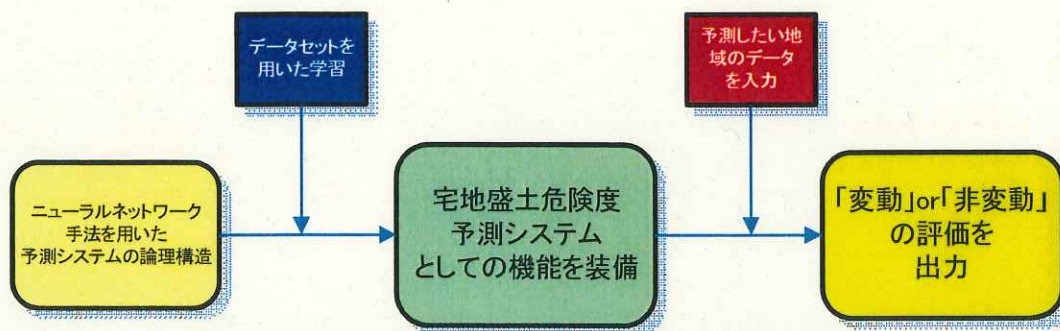
図 4.3 宅地盛土危険度判定システムの概念図
