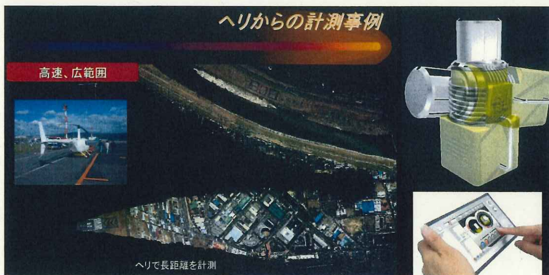
図 3.1.7 3D レーザースキャナにより現地形を計測する新技術の例 (地層科学研究所の Geo-Scanner LISA 資料から抜粋)
